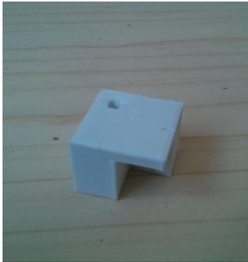
(a) 3D gedrucktes Eckstück
